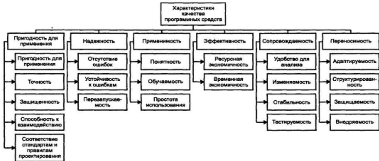
Рис. 45. Схема характеристик качества ПС по стандарту ISO 9126:1991
