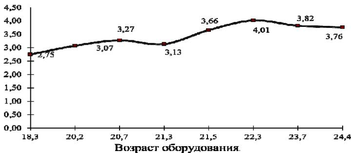
Рис. 8.2. Зависимость затрат на ремонт от возраста оборудования
